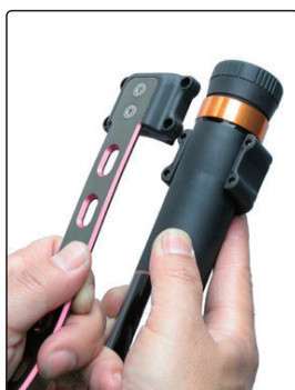
② お手持ちの柄に装着します。取付け位置の対応直径は、29.9mm~35.3mmです。
